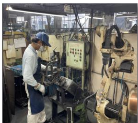
半自動溶接の様子
