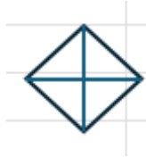
Hình 12-7. Hình ảnh vết lõm Micro Vickers
