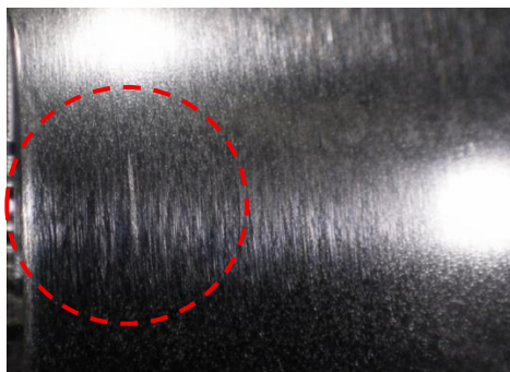
Hình 13-11. Vết xước khi đánh bóng buff
