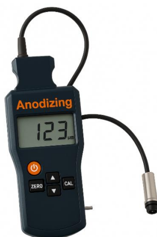
Hình 12-6. Máy đo độ dày màng bằng dòng điện xoáy
