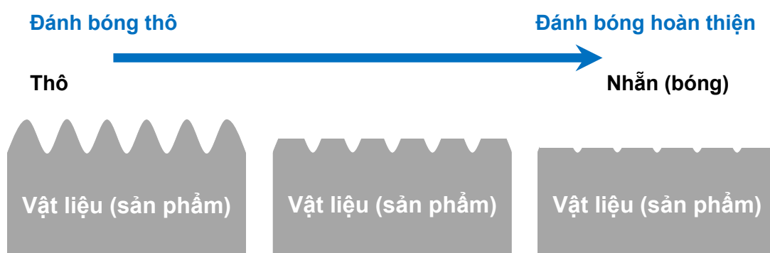
Hình 13-3. Sự thay đổi bề mặt vật liệu khi đánh bóng buff
