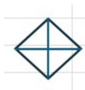
図 12-7 マイクロビッカース圧痕のイメージ
