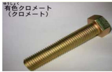
図 7-3 亜鉛めっきのクロメート処理
