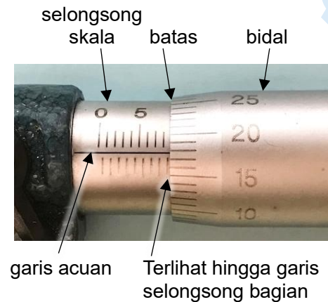
Gambar 7-6: Cara Membaca Mikrometer
