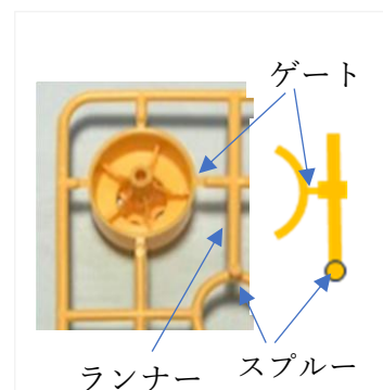
図12-2 金型中の注入経路
