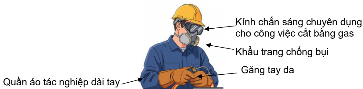
Hình 8-1. Ví dụ về trang phục và dụng cụ bảo hộ phù hợp khi thực hiện công việc cắt bằng gas
