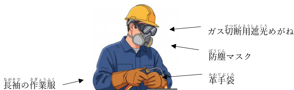
図 8 - 1 ガス切断作業を行う場合に適した服装と保護具の例
